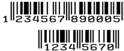
DUN 14 (Despatch Unit Number), es la denominación de una estructura numérica utilizada para identificar a las unidades de empaque, mientras que el ITF (Interleaved 2 of 5) es la simbología de códigos de barras utilizada para representar gráficamente al DUN-14. Se pueden utilizar como variable de logística entre el valor 1 y 8 , el cero no se utiliza por carecer de lectura y poder ser confundido con un cod EAN13, y el numero 9 se utiliza para reflejar unidades variables(ej. Pesables)
