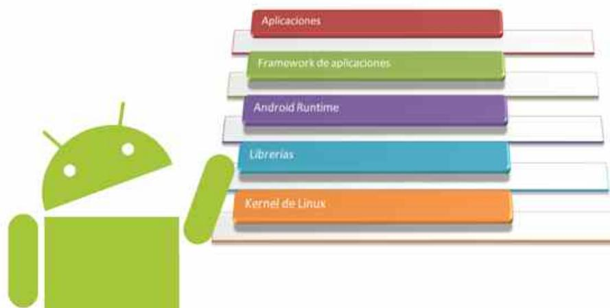
La pila en la arquitectura Android, permite observar como las aplicaciones hacen uso de sus capas inferiores, permitiendo entender el funcionamiento de ellas y como hacen uso de los diferentes software hasta arribar al propio kernel del sistema operativo subyacente, comprender este funcionamiento permite la creación de sistemas para ser utilizados en dispositivos móviles sobre el sistema operativo Android.
