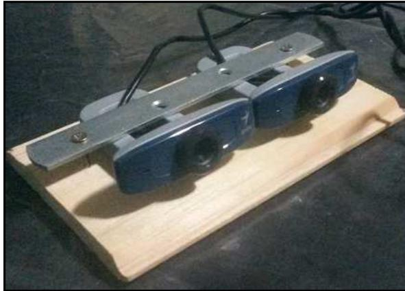
*Figura 6.4 - Disposición de las cámaras para simular el sistema estéreo.*
